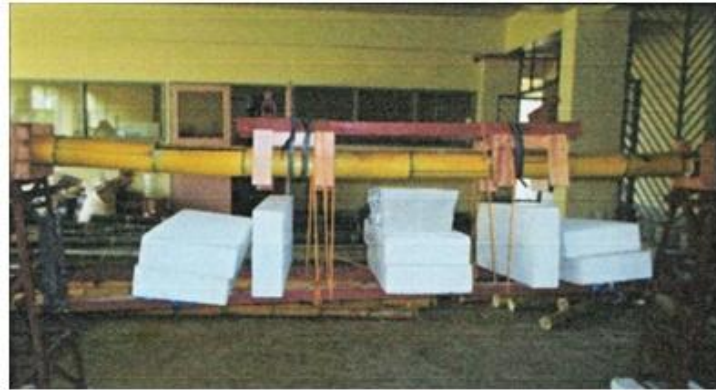
Fig. 5. Actual test set-up for flexural test
